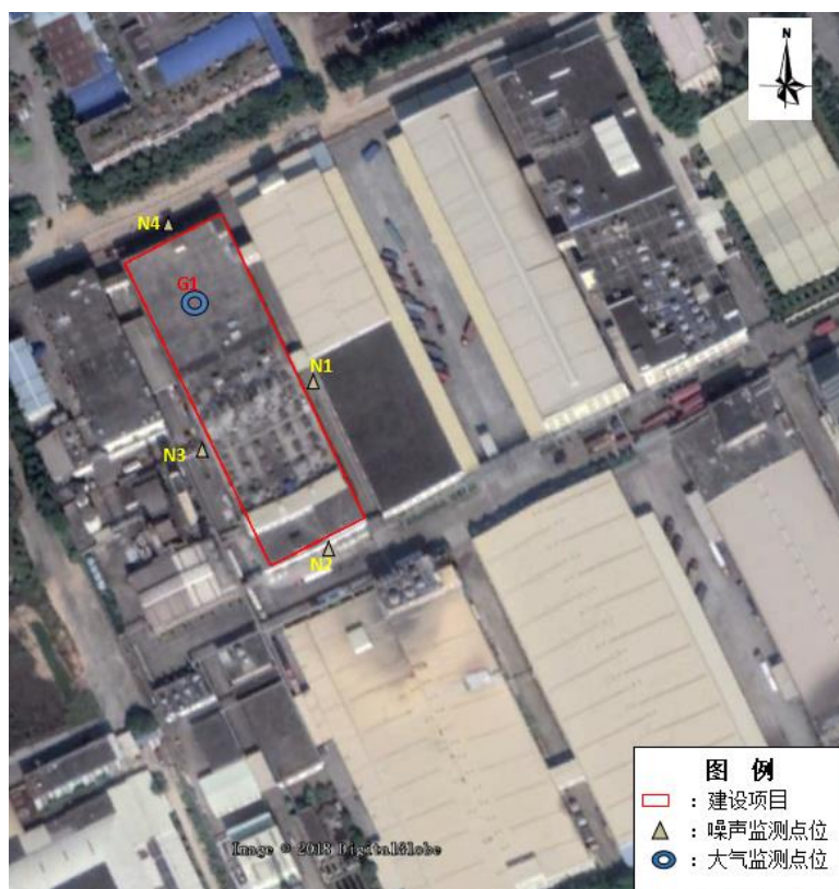
图 7.1.1 废气、噪声监测点位布置图
